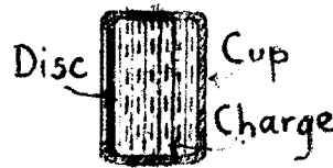
Fig 1-34 TYPICAL STAB FUZE PRIMER
